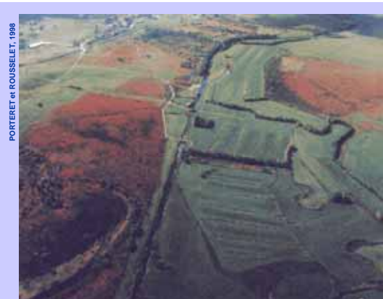
Vallée du Drugeon à Sainte Colombe : avant travaux de restauration, un chenal rectiligne fait place au cours originel sinueux dont on voit les anciens méandres.
